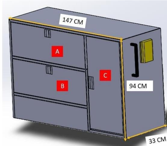
Y UN COMPARTIMIENTO SUPERIOR QUE ABRIRÁ HACIA AFUERA (D), TODAS CON CHAPA DE ALTA DURABILIDAD, SE SUSTENTAN POR MEDIO DE CABLES DE ACERO Y LLEVAN UN CONTRAMARCO DE GOMA ANTI RUIDO PARA EVITAR VIBRACIONES, TERMINADAS EN COLOR ALUMINIO.
