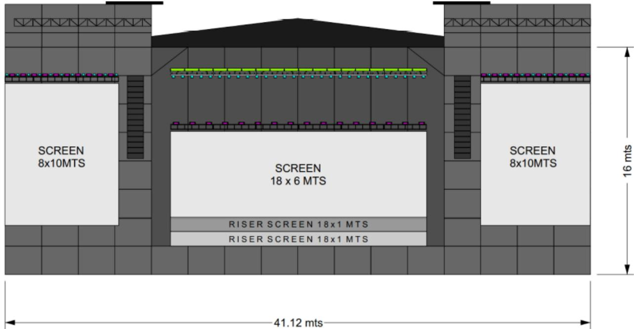
**OBSERVACIONES:** Instalación de escenario híbrido, compuesto por Ground Support de 10 patas para elevar el mother grid o parrilla a 12 metros de altura, sobre la cual se instalarán los puentes de iluminación y video. Scaffold o paredes laterales elaboradas con sistema Layher, con una altura total de 10 metros, sobre las cuales se hará el rigging del audio y pantallas de CCTV. El contrapeso del soporte será con 6 bidones de agua (1000lts c/u), y enlaces con paredes de layher.
